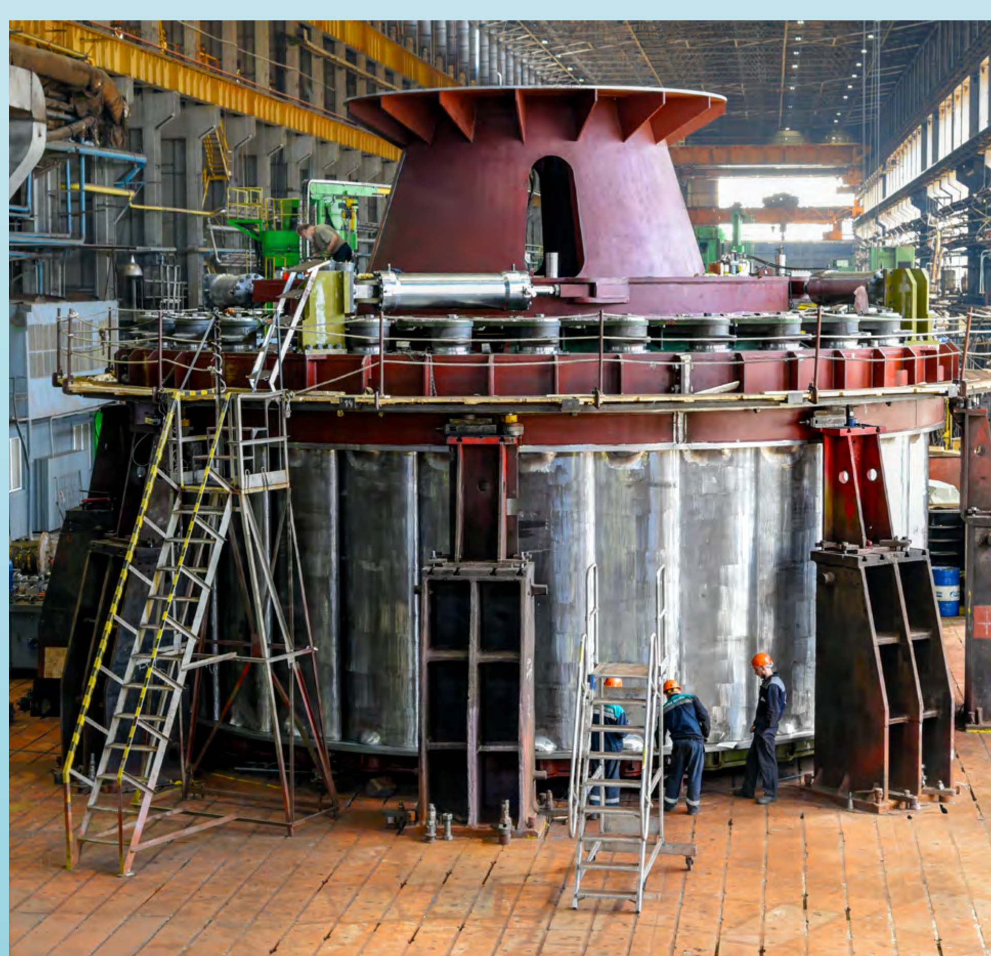
Подготовка направляющего аппарата Воткинской ГЭС к заводским испытаниям
